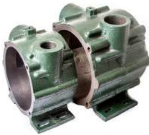
CARCAÇAS DE BOMBAS DE VÁCUO
